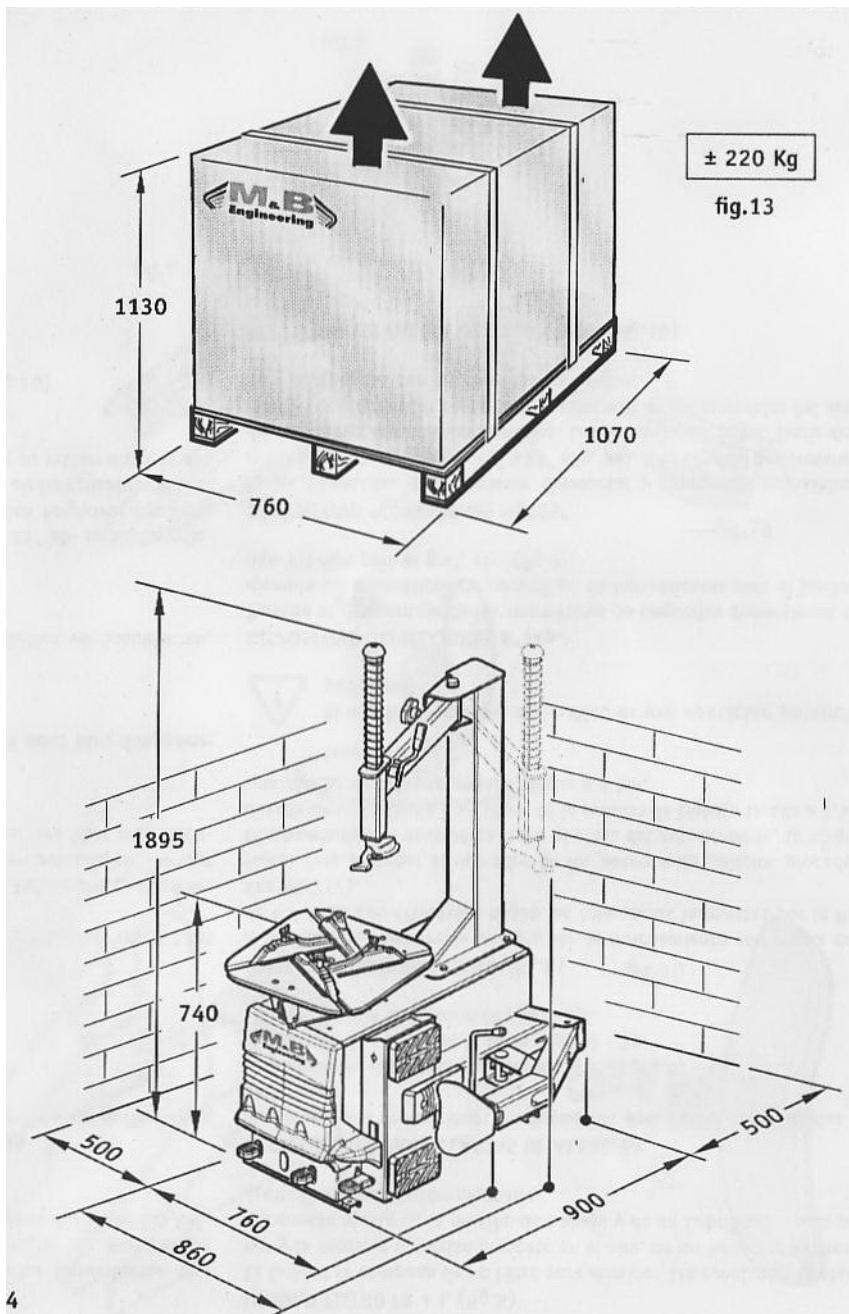
Когда вы получите упакованный станок, уберите пластиковые ленты (будьте осторожны при их разрезке) и снимите картонную коробку как показанно на рис.13. Проверьте, всё ли на месте и нет ли повреждений станка. Если вы сомневаетесь, неработайте на станке, а обратитесь к квалифицированному персоналу и/или к продавцу.
