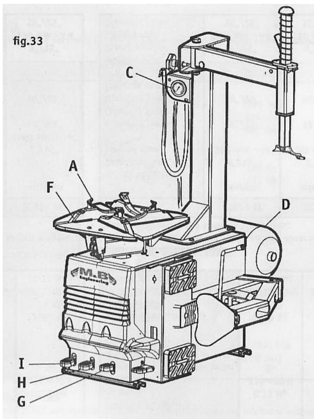
Версия станка TC322 IT - это полуавтоматический шиномонтажный станок, предназначенный для работы с **безкамерными шинами**. В сравнении с базовой моделью станка этот станок имеет следующие компоненты (смотрите рис. 32):
