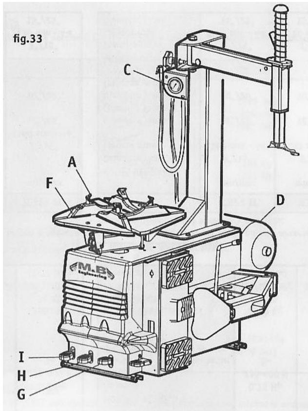
Версия станка ТС322 ИТ - это полуавтоматический шиномонтажный станок, предназначенный для работы с **безкамерными шинами**. В сравнении с базовой моделью станка этот станок имеет следующие компоненты (смотрите рис. 32):
