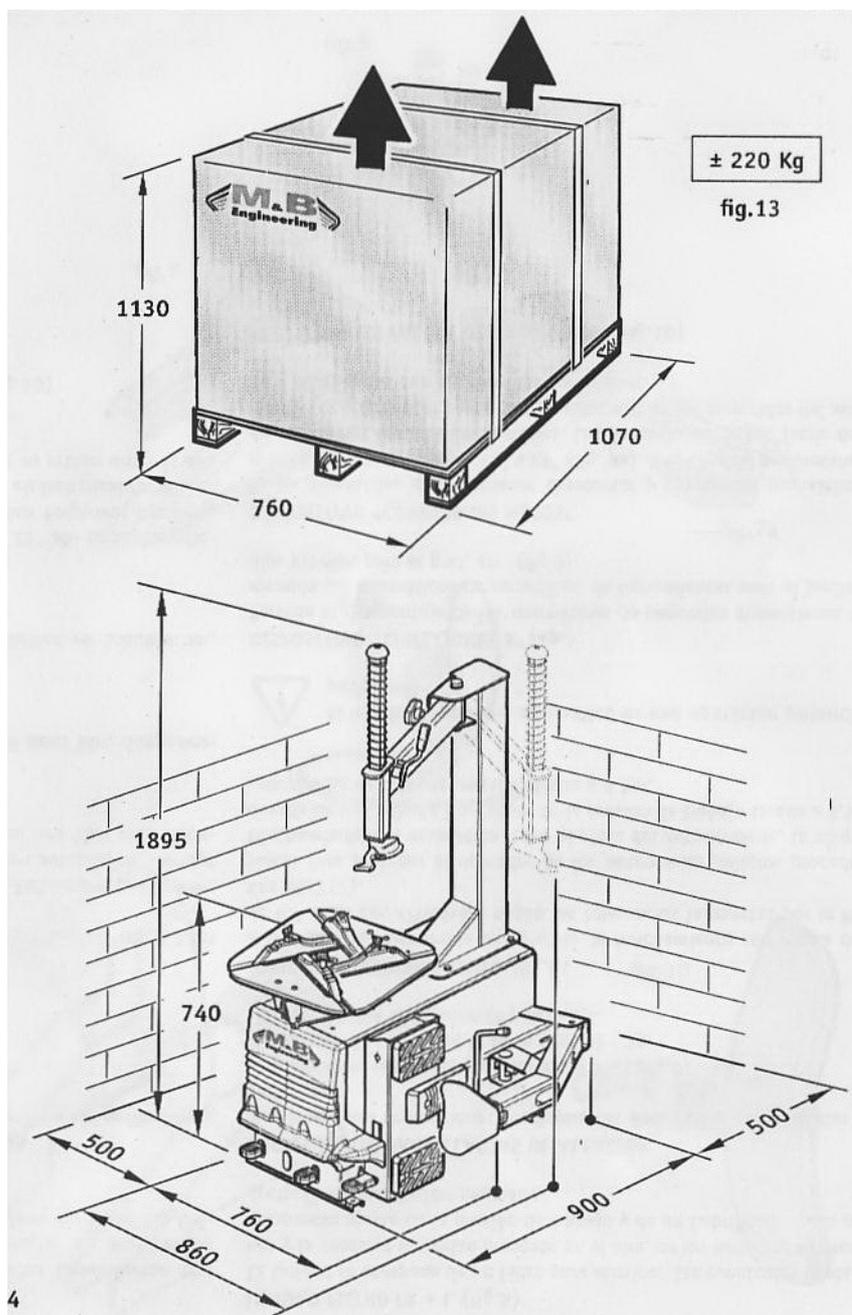
Когда вы получите упакованный станок, уберите пластиковые ленты (будьте осторожны при их разрезке) и снимите картонную коробку как показано на рис.13. Проверьте, всё ли на месте и нет ли повреждений станка. Если вы сомневаетесь, не работайте на станке, а обратитесь к квалифицированному персоналу и/или к продавцу.
